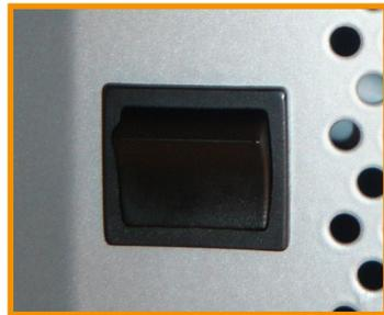
Mit dem Kippschalter unter dem NOT-AUS-Taster lässt sich die Beschleunigung des Luftschleiers in zwei Stufen ändern.
